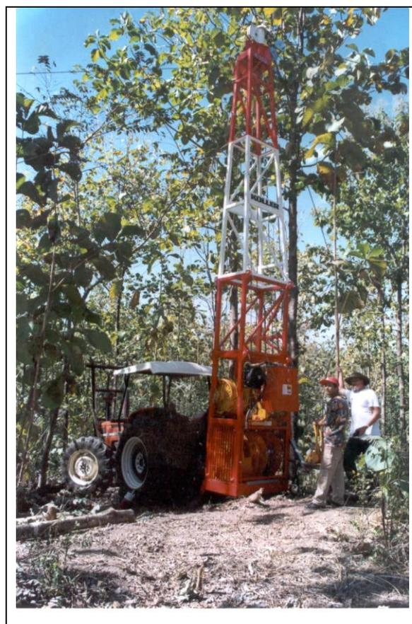
Foto 4.3. Sistema de extracción con cables aéreos (H. Tanner)
